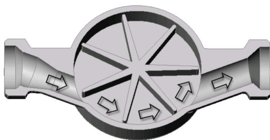
Principio de funcionamiento contador de chorro único
