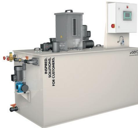
En el sistema de 3 cámaras, el polímero se disuelve en agua en la primera cámara. En la segunda cámara, el polímero madura. A través del rebosadero, la solución acabada llega a la tercera cámara, de donde se extrae. Mediante un proceso adaptado de forma óptima a la tarea, se minimiza el remanente del producto.
