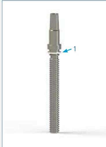
**04:** Eje y valona de una única pieza en acero inoxidable para una **mejor resistencia a cargas axiales y para soportar pares de maniobra superiores**. Una arandela de poliamida (1) colocada bajo la valona permite reducir la fricción y protege el recubrimiento interior de la tapa.
