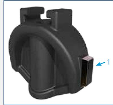
**07: Sistema de guiado con guías macho de composite (1)** reduce el desgaste del cierre contra el cuerpo, permitiendo un funcionamiento suave y una mayor vida útil de la válvula. Además, el aumento del espesor del elastómero en las áreas de sellado mejora la resiliencia del producto a las pequeñas impurezas que circulan por las redes.
