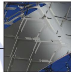
Tamiz de acero inoxidable de malla metálica para minimizar las pérdidas de carga y anillos de refuerzo para evitar deformaciones a altas presiones.
