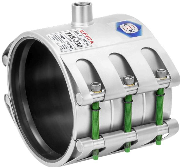
Abrazadera de junta bilabial hidráulica con derivación roscada para intercalar, reparar o conectar tuberías de diversos materiales y a la vez disponer de una conexión para instalar distintos elementos. La derivación está unida a la carcasa mediante cordón de soldadura y la junta de estanqueidad está adaptada a la nueva geometría interior de la carcasa. En función del tamaño de rosca de salida requerida, se elegirá el ancho óptimo de la carcasa.
