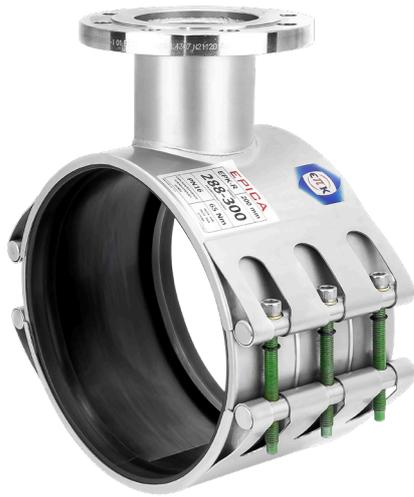
Abrazadera de junta bilabial hidráulica con derivación embridada para intercalar, reparar o conectar tuberías de diversos materiales y a la vez disponer de una conexión para instalar distintos elementos. La derivación está unida a la carcasa mediante cordón de soldadura y la junta de estanqueidad está adaptada a la nueva geometría interior de la carcasa. En función del tamaño de brida de salida requerida, se elegirá el ancho óptimo de la carcasa.
