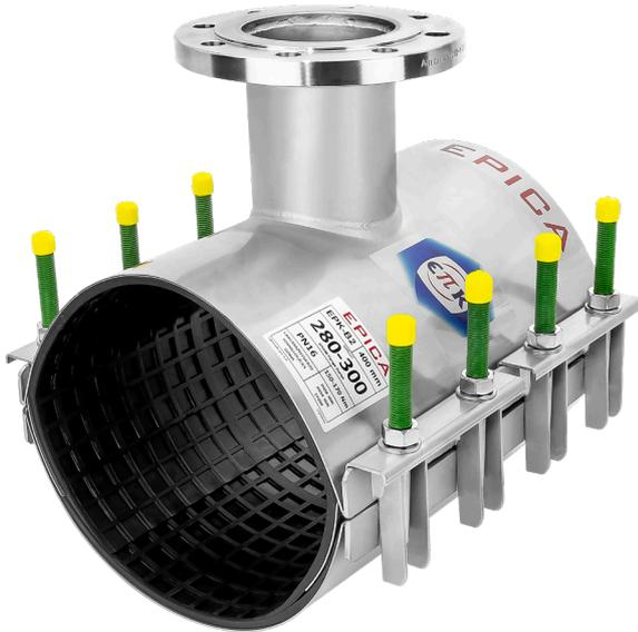
Abrazadera de banda con derivación embreada unida a la carcasa mediante cordón de soldadura y la junta de estanqueidad está adaptada a la nueva geometría interior para reparar y conectar tuberías de diversos materiales y a la vez disponer de una conexión para instalar distintos elementos. En función del tamaño de brida de salida requerida, se ofrecerá el ancho óptimo de la carcasa.
