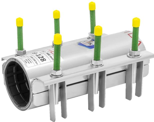
EPK-B2 diseñada para reparar y conectar tuberías de diversos materiales. Sus 2 cierres le confieren una tolerancia de hasta 20 mm y sus mayores anchos le permiten alcanzar diámetros superiores de tubería. Está diseñada para facilitar el montaje, no existiendo elementos sueltos.
