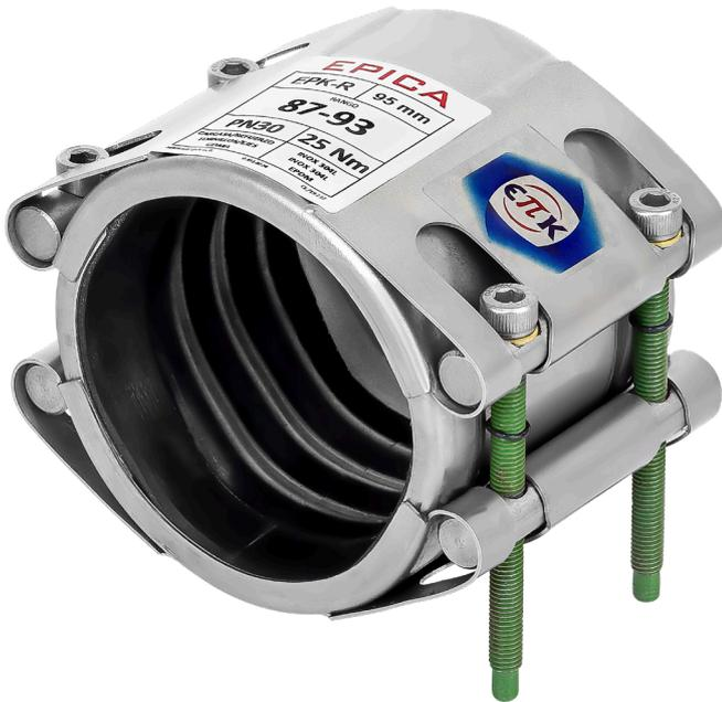
Abrazadera de junta bilabial hidráulica con un ancho de 95 mm para reparar y conectar tuberías de diversos materiales y presiones, preparada para ser instalada en condiciones adversas ya que toda la ingeniería de EPIKA está enfocada a facilitar el montaje, como el eje anticaída o los tornillos extra-largos con punta guía.
